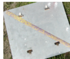
Figuur 22: Visualisatie van het spuitbeeld op watergevoelig papier
