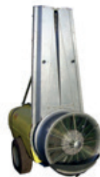
Figuur 7: Dwarsstroomspuittoestellen met luchtgeleiders
